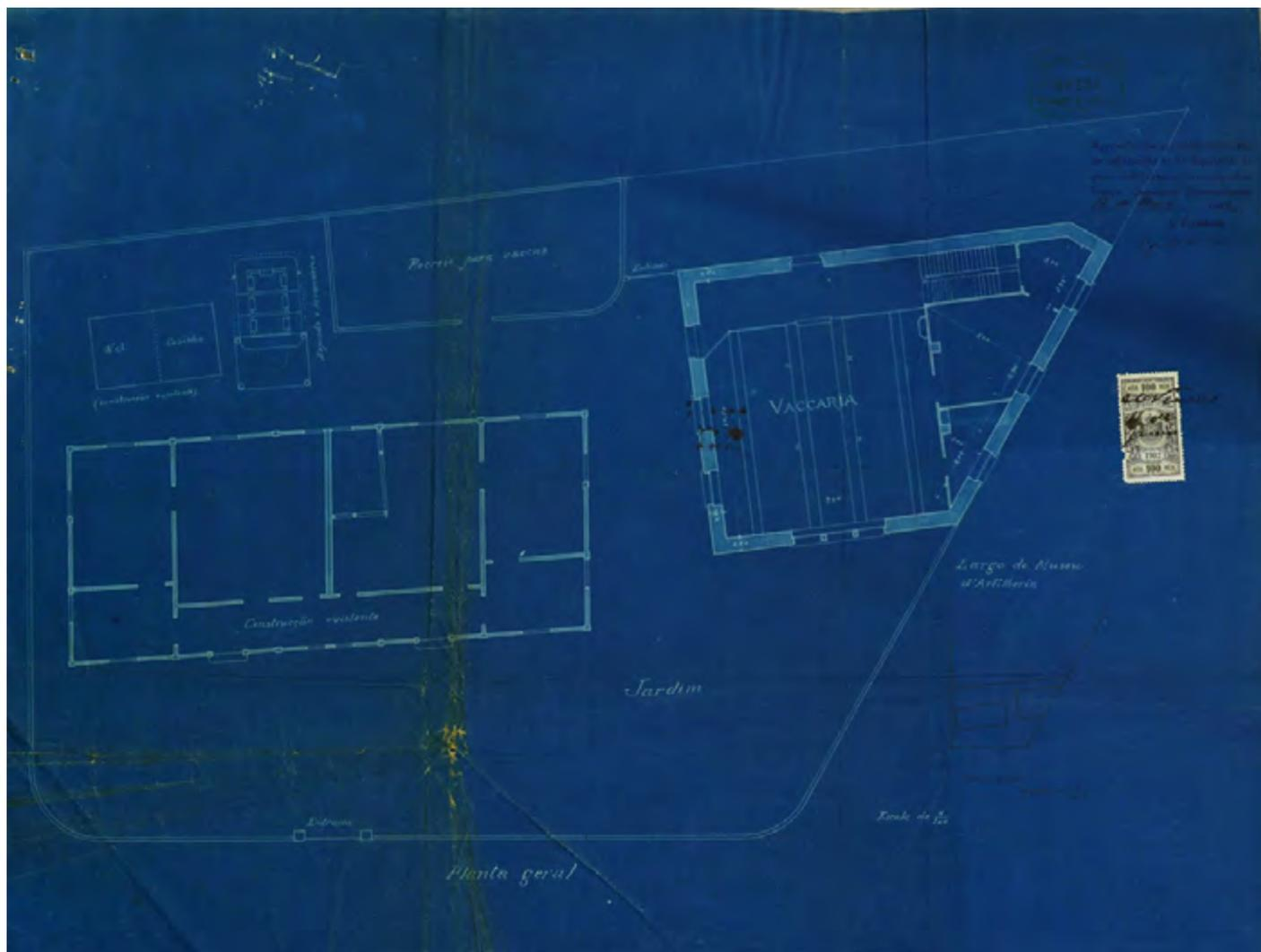
**Figura 11** Projeto do arquiteto Ventura Terra, com a data de 11 de janeiro de 1902 aposta no selo. À esquerda, o edifício pré-existente adaptado às necessidades da APPI; à direita, a vacaria e as respetivas dependências, a construir de raiz. AML, Obra nº 28677, Volume 1, Processo nº 193/1ªREP/PG/1902, p. 5.
