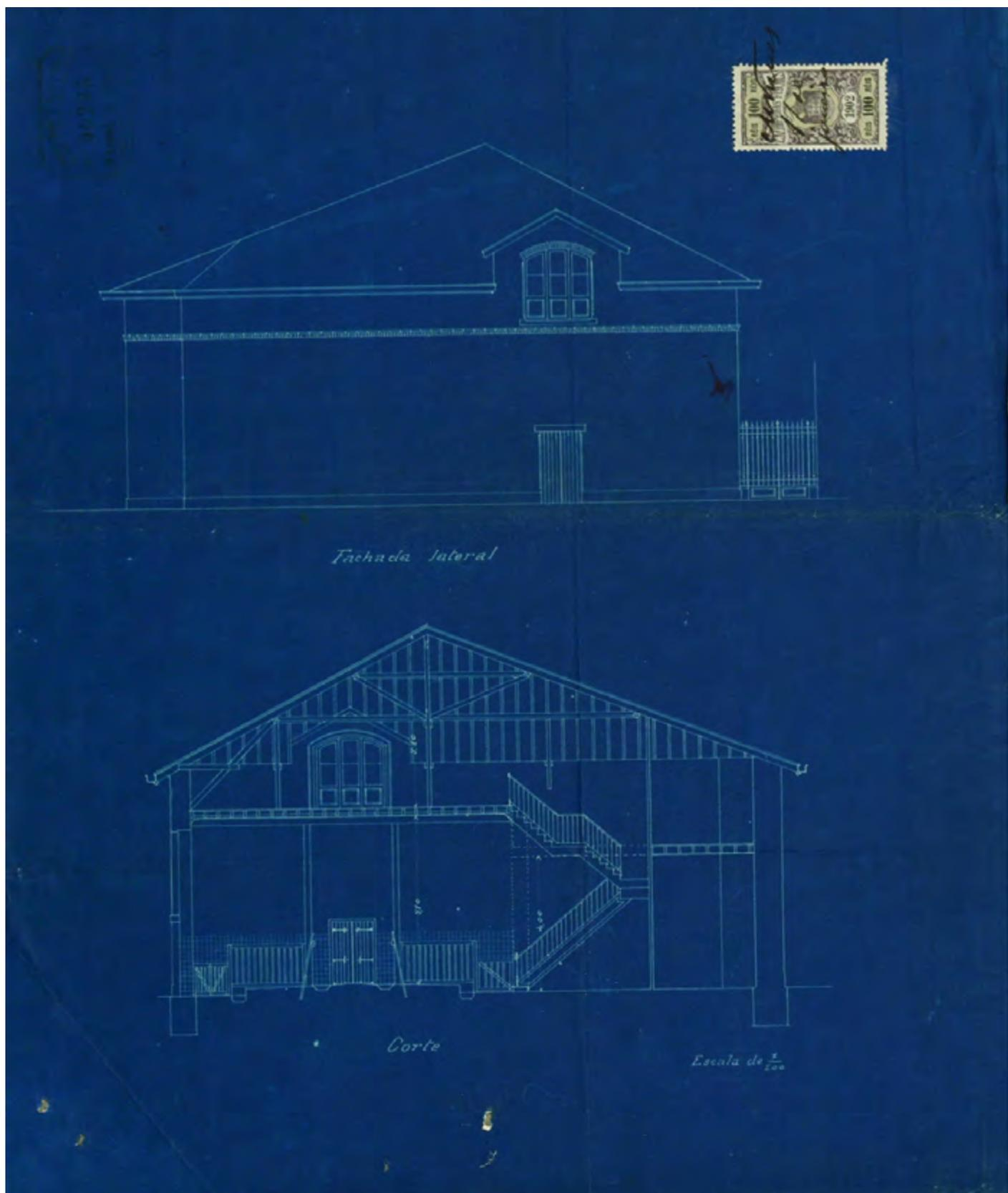
**Figura 14** Fachada lateral e corte da vacaria a construir nos terrenos cedidos pela CML, para 18 cabeças de gado, projeto do arquiteto Ventura Terra. Para além do estábulo, o edifício acolhia o "Serviço de Lactologia" e a habitação do vaqueiro. AML, Obra nº 28677, Volume 1, Processo nº 193/1ºREP/PG/1902, p. 4.
