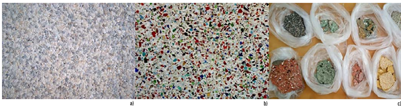
Figura 6 Pormenores de revestimentos de marmorite: a) fachada do edifício principal do LNEC (2017); b) fachada de edifício de Palmela (2017); c) amostras para ensaio (2017). Fotografias de António Santos Silva.
