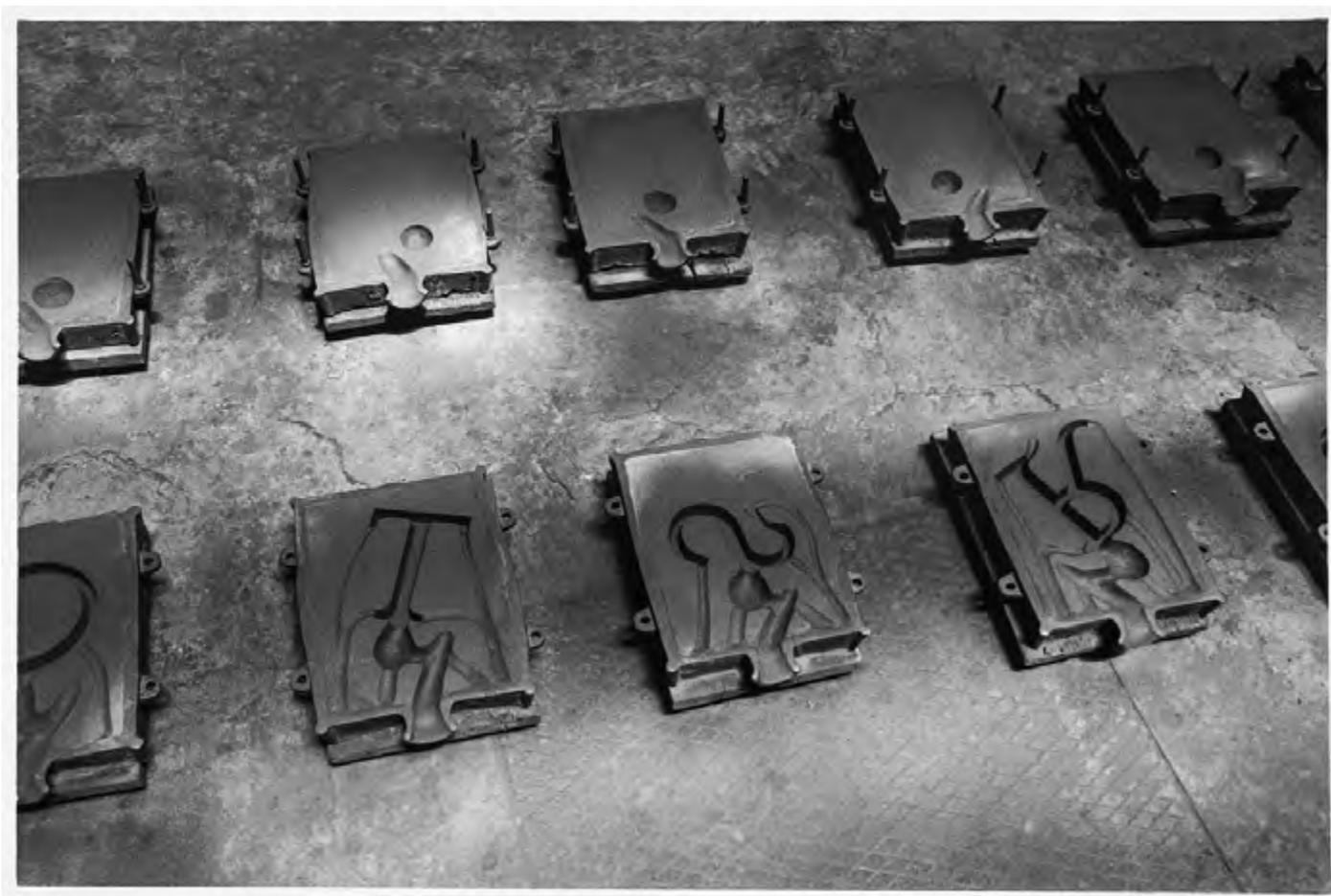
**Figura 20** Moldes perfilados para fundição<sup>23</sup>. AML, PT/AMLSB/MAP/000048.
