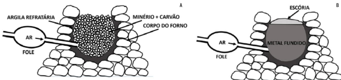
**Figura 18** Forno primitivo para fusão do ferro. Legenda: a) Carga do forno alimentado com minério e carvão misturados por camadas; b) Depois da operação de aquecimento o metal fica no fundo e a escória sobrenada. Desenho do autor.
