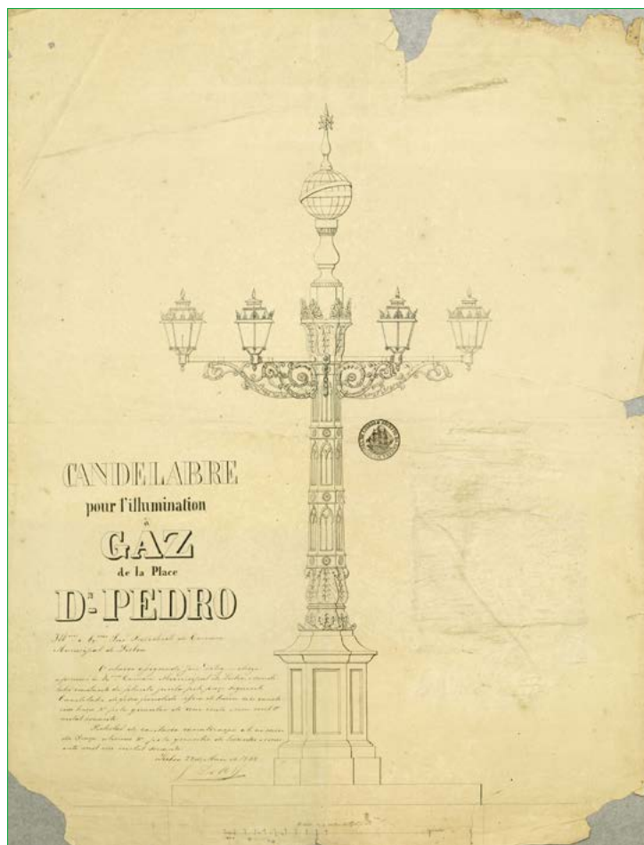
Desenho de candelabro com iluminação a gás, na praça D. Pedro IV (Rossio). Candelabro de ferro fundido, esfera de bronze, com seis candeeiros de braço, pedestal de cantaria, a adquirir pela CML, pela quantia de 1 conto e 100 mil réis o candelabro, e 350 mil réis o pedestal, 28-05-1849. AML, PT/AMLSB/CMLSB/UROB-PU/11/775, p. 1.
