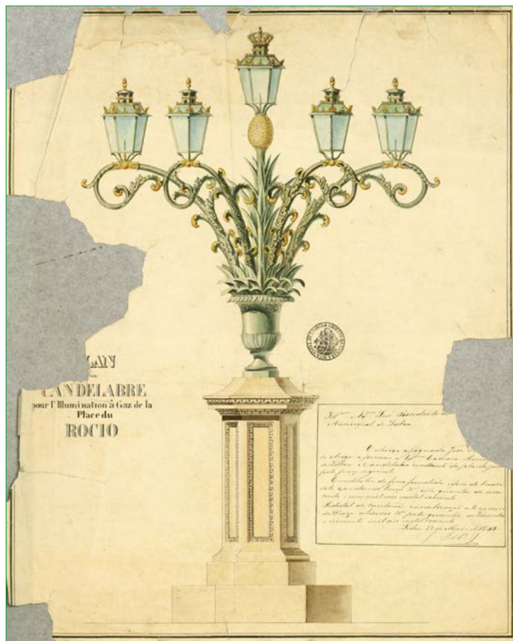
Desenho de candelabro com iluminação a gás, na praça D. Pedro IV (Rossio). Candelabro de ferro fundido, esfera de bronze, com sete candeeiros de braço, e pedestal de cantaria, adquiridos pela CML pela quantia de 50 mil réis, 22-05-1849. Arquivo Municipal de Lisboa (AML), PT/AMLSB/CMLSB/UROB-PU/11/774, p. 1.
