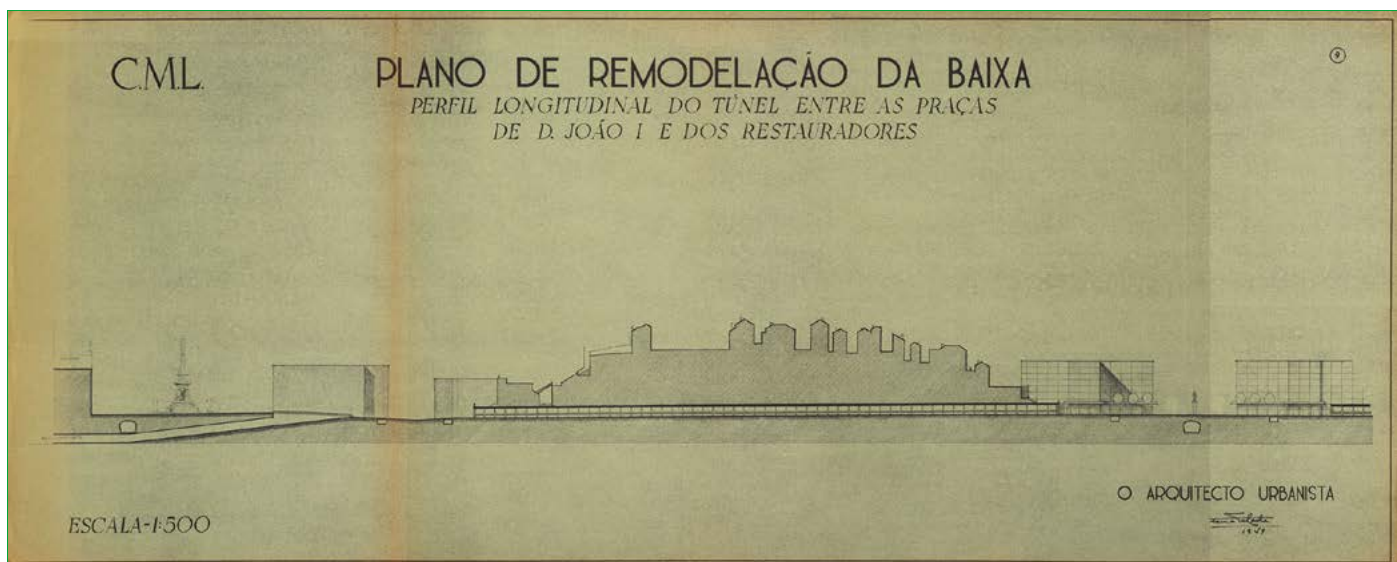
Plano de remodelação da Baixa elaborado pelo arquiteto urbanista Faria da Costa, na Direcção dos Serviços de Urbanização e Obras. Inclui as plantas do conjunto e o perfil longitudinal do túnel a ser projectado entre as praças de D. João I e dos Restauradores, 1949-1950. AML, PT/AMLSB/CMLSB/UROB-PU/10/432, p. 4.
